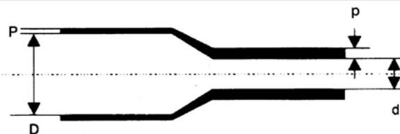
El FKM es un tubo muy resistente tanto a las altas como a las bajas temperaturas sin que aparezcan roturas. Fabricado con un elastómero fluorado modificado se usa para aplicaciones donde se requiera la resistencia a altas temperaturas. Posee igualmente un gran resistencia a los disolventes y otros productos químicos. Para la protección de cables, uniones, conectores, componentes, etc. como sustituto perfecto al tubo de silicona. Ratio de contracción **2:1**.
