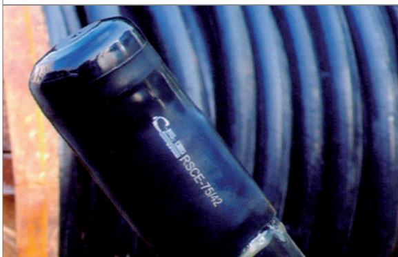
El protector de extremo de cable **RSCE** (sin válvula) y **RSCEA** (con válvula) se utiliza en cables de alimentación XLPE o PILC, así como en cables de telecomunicaciones. Recubierto en el interior con adhesivo de fusión en caliente que proporciona, aparte de aislamiento eléctrico, un sellado óptimo contra al agua y la corrosión y abrasión químicas de los extremos de los cables durante su almacenamiento, transporte e instalación.
